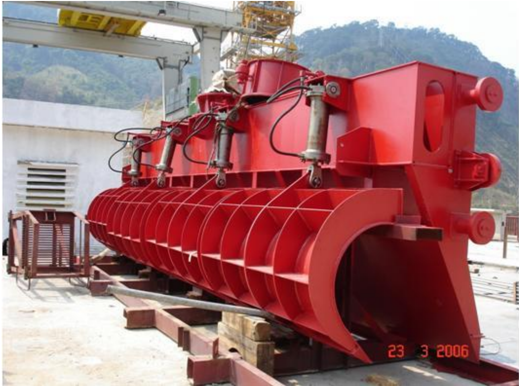
Gầu vớt rác kích thước lớn, độ bền cao, hoạt động tin cậy lắp trên các cửa nhận nước của nhà máy thủy điện
